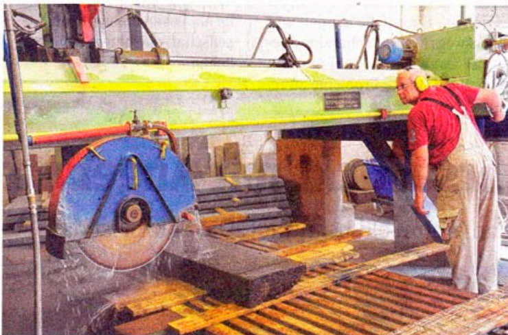
Das mächtige Segeblatt einer Steinsäge durchtrennt in Georges Werkstatt einen Basaltstein, der aus der Eifel nach Duisburg geliefert wurde.
